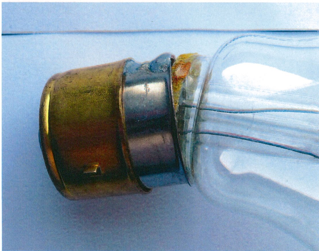
Рис.7 Отделение внутреннего стакана
