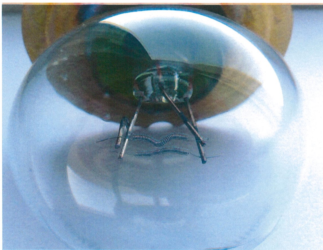
Рис.16 Перекрученная спираль
