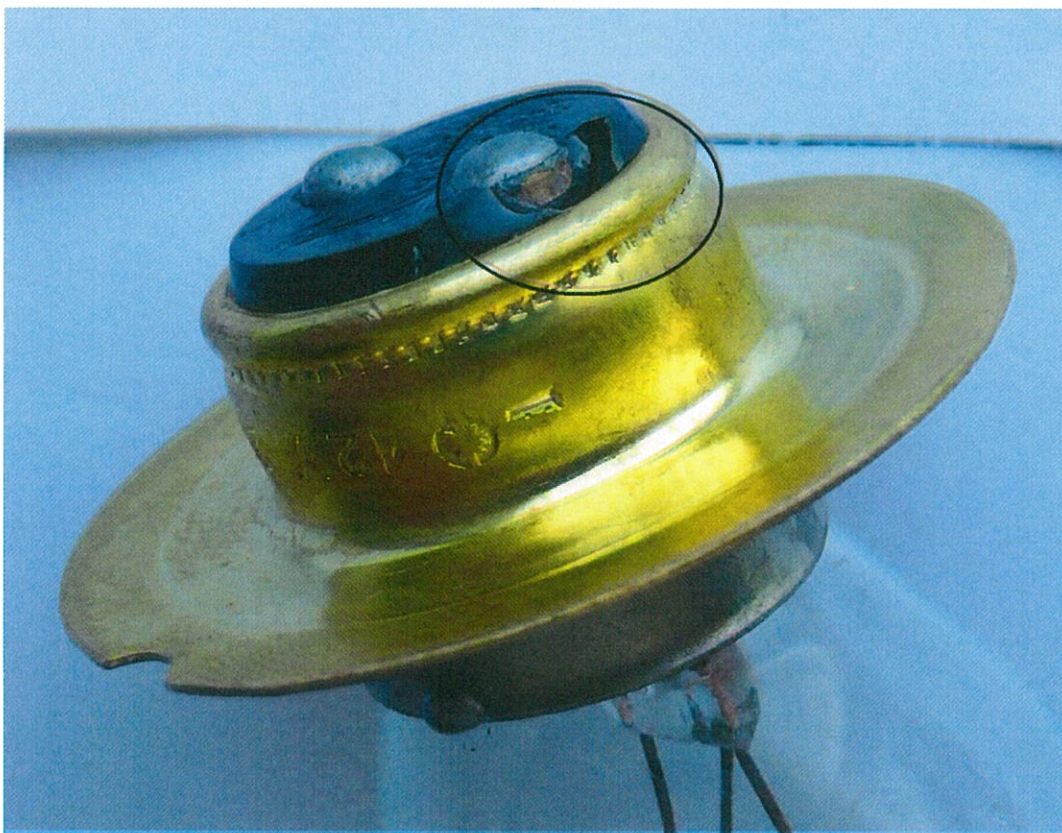
Рис.15 Разрушение изоляционного стекла
