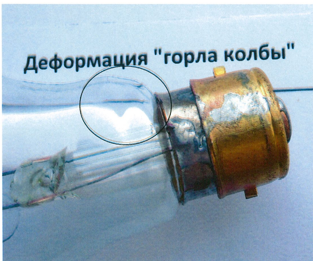
Рис.8 Деформация горла колбы
